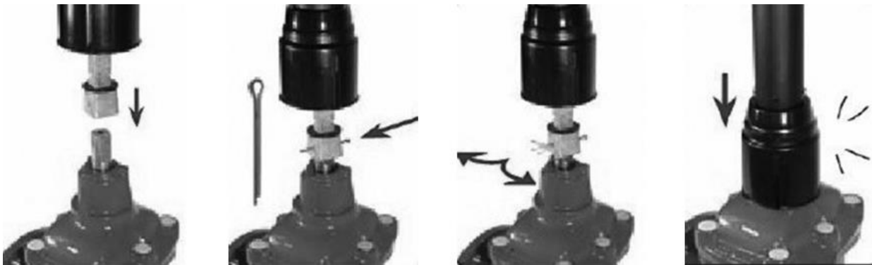
Рис. 4 Порядок установки телескопического штока на задвижку.
